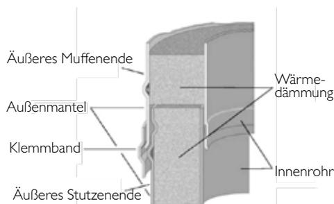
Das PERMETER-Innenrohr ist aus Edelstahl mit der Werkstoff-Nr. 1.4521 gefertigt. Der Außenmantel besteht aus pulverbeschichtetem Stahl und übernimmt die statischen Lasten. Der Zwischenraum ist mit einer 25 mm (bzw. altern. 50 mm) dicken, speziellen „Super-Wool“ gefüllt. Die einzelnen PERMETER-Elemente werden durch die Steckverbindung einfach zusammengefügt und mittels mitgelieferten Klemmbändern gesichert.
